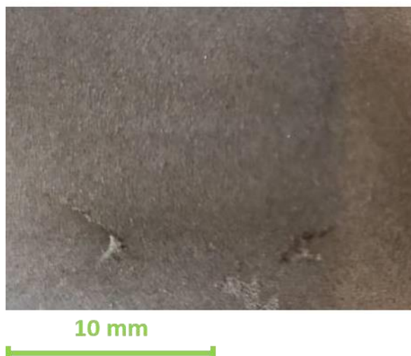
Obr. 4.9 Trhliny vzniknuté na obrobenej ploche.
