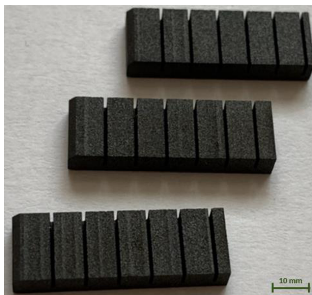
Obr. 4.11 Vzorky SiSiC po WEDM rezaní.
