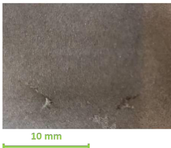
Obr. 4.9 Trhliny vzniknuté na obrobenej ploche.
