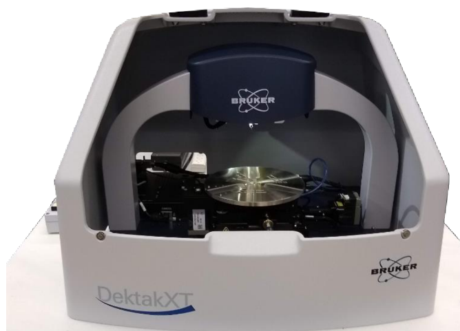
Obr. 4.15 Profilometer Bruker Dektak XT [54].
