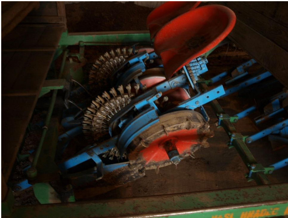
Obr. č. 8 Sedadlo a podávací ústrojí školkovacího stroje
