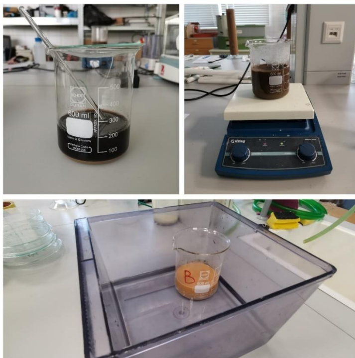
Obr. 6: Půdní vzorek po smíchání s dispergačním činidlem (vlevo nahoře), vaření půdního vzorku na magnetické míchače Witeg MSH-20A (vpravo nahoře) a chlazení vzorku ve vodní lázni (dole).
