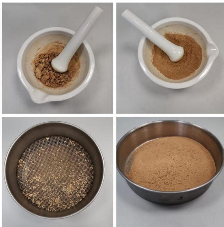
Obr. 5: Příprava jemnozeme – rozrušení pseudoagregátů v třecí misce (nahore) a následné prosetí přes síto o průměru ok 2 mm za účelem oddělení skeletu (nadsítná frakce) od jemnozeme (podsítná frakce).
