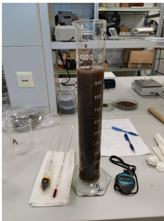
Obr. 8: Stanovení zrnitostního složení půdy hustoměrnou metodou.
