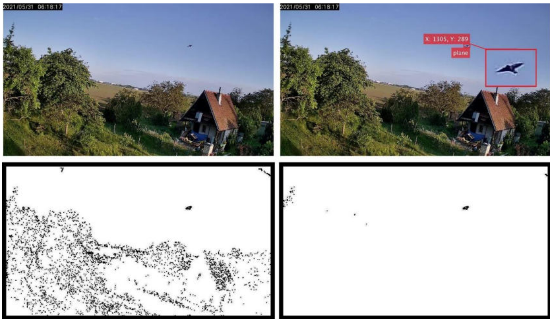
Obr. 7.5: Nesprávne rozpoznanie vtáka ako lietadla (vpravo hore), originálna snímka (vľavo hore), pôvodná diferenčná snímka s pohybovými príznakmi (vľavo dole), maskou filtrovaná diferenčná snímka (vpravo dole).
