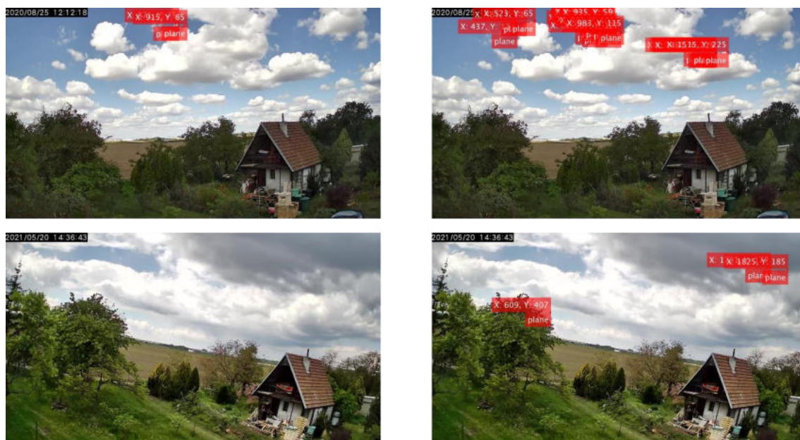
Obr. 7.8: Porovnanie modelu klasifikátora využívajúceho iba SIFT deskriptory (vľavo) s modelom klasifikujúcim na základe SIFT aj RGB príznakov (vpravo).
