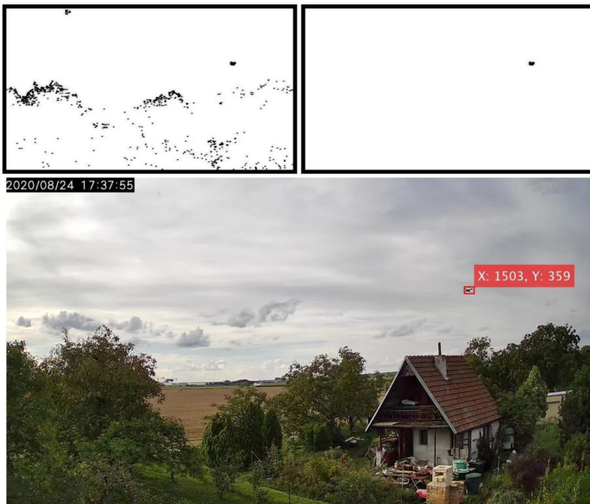
Obr. 5.3: Invertovaná binárna rozdielová snímka pred (vľavo hore) a po úpravách (vpravo hore), finálna lokalizácia letiaceho objektu v snímke z videosekvencie (dolu).
