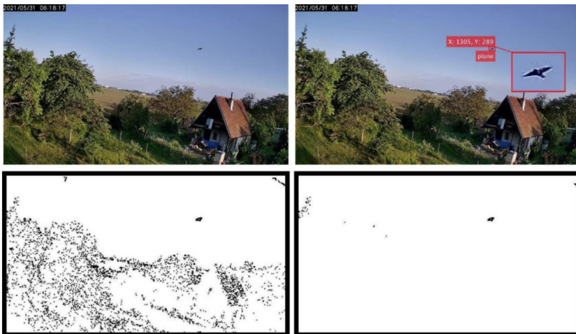
Obr. 7.5: Nesprávne rozpoznanie vtáka ako lietadlo (vpravo hore), originálna snímka (vľavo hore), pôvodná diferenčná snímka s pohybovými príznakmi (vľavo dole), maskou filtrovaná diferenčná snímka (vpravo dole).
