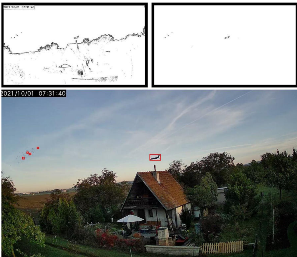
Obr. 5.4: Invertované zobrazenie hrán pred (vľavo hore) a po úpravách (vpravo hore), finálna detekcia letiacich objektov v samostatnej snímke (dolu). Pre prehľadnosť nie sú zobrazené súradnice.
