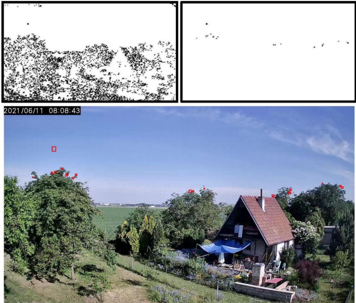
Obr. 5.5: Invertovaná binárna rozdielová snímka pred (vľavo hore) a po úpravách (vpravo hore), finálna lokalizácia letiaceho objektu na oblohe aj pohybujúcich sa objektov v okolí, ktoré sa nepodarilo odfiltrovať maskou (dolu). Pre prehľadnosť nie sú zobrazené súradnice.
