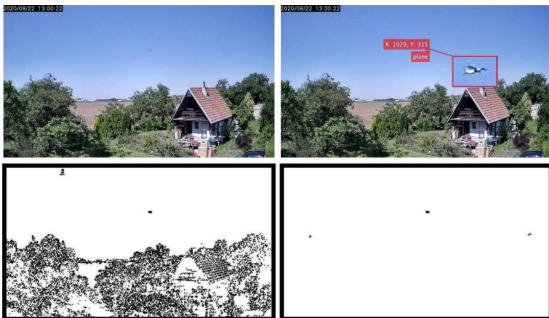
Obr. 7.2: Správna detekcia lietadla (vpravo hore), originálna snímka (vľavo hore), pôvodná diferenčná snímka s pohybovými príznakmi (vľavo dole), maskou filtrovaná diferenčná snímka (vpravo dole).
