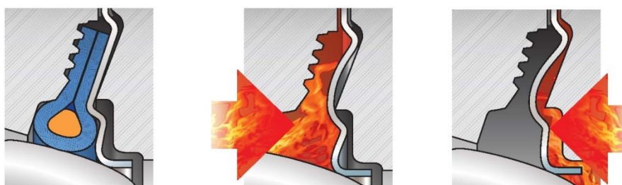
Obr. 3) Funkce kovového těsnění při požáru [23]
