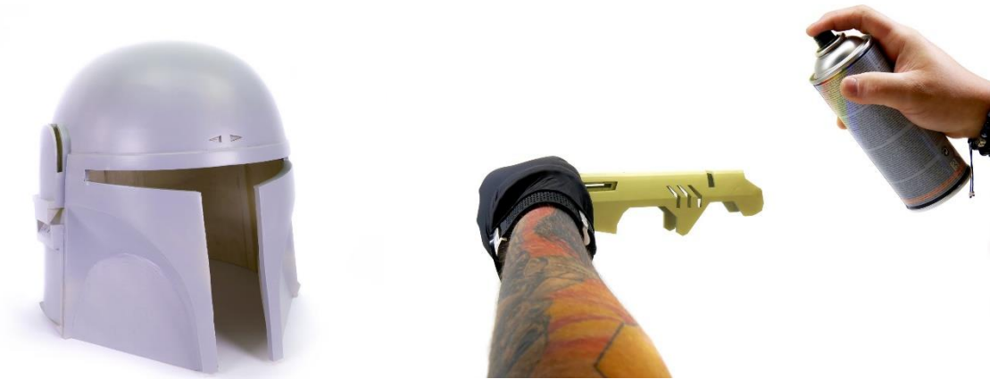
Obr. 21 Tmelený model (vlevo) a aplikace plniče ve spreji (vpravo) [40].
