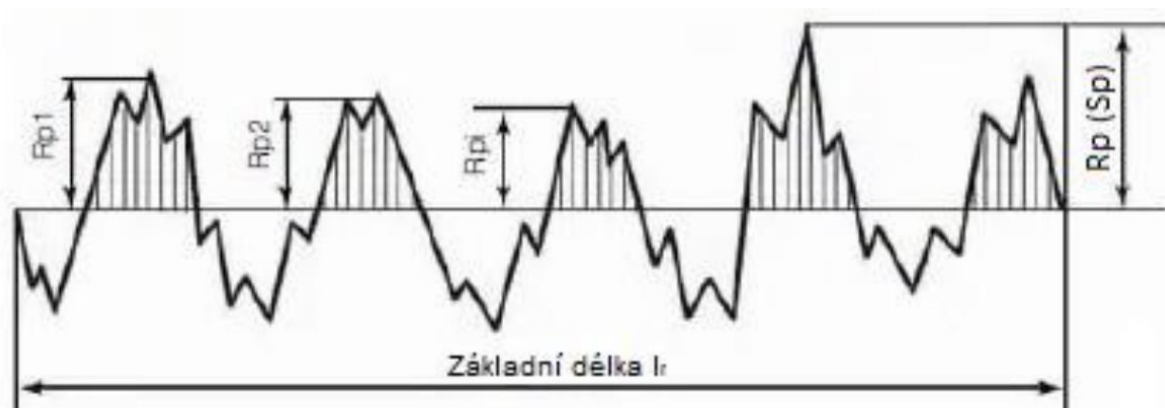
Obr. 27 Grafické znázornění parametru R_p [48].
