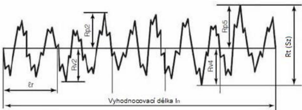
Obr. 29 Grafické znázornění parametru drsnosti R_t [48].
