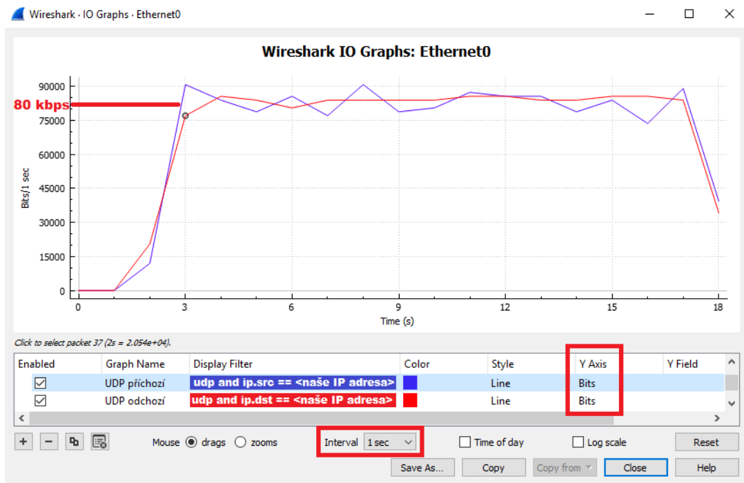
Obr. D.2: Zobrazení toku protokolu UDP pro příchozí a odchozí hovory, kde počet bitů přenesených za 1 sekundu odpovídá udávanému bitratu kodeku PCMU 80 kbit/s.
