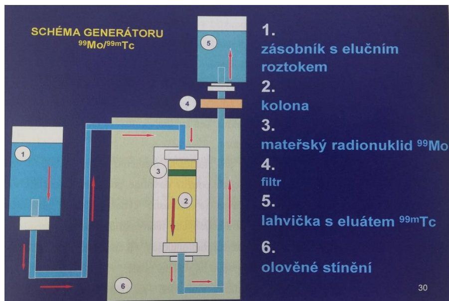
Obrázek 2 Schéma generátoru ^{99}\text{Mo}/^{99\text{m}}\text{Tc} , Zdroj: (Kraft & Pekárek, 2014)
