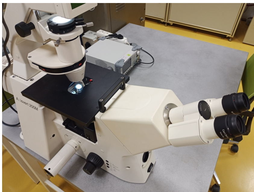
Obrázek 5.48 Inverzní mikroskop Zeiss Axiovert 200M
