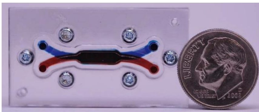
Obrázek 1.14 Mikrofluidní systém „srdce na čipu“ (převzato z [65])
