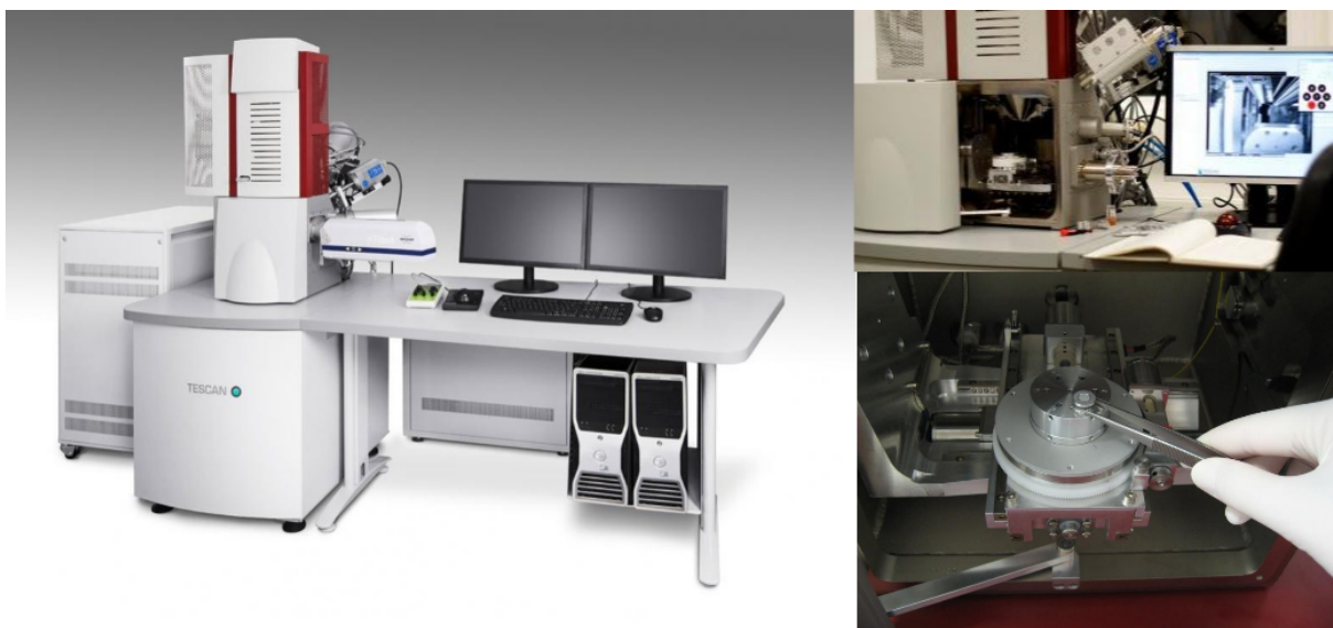
Obrázek 3.5: Pracovní stanice s rastrovacím elektronovým mikroskopem TESCAN Lyra3 XMH FIB-SEM. Vpravo nahoře je vidět zaváděcí komora a vpravo dole pak držák vzorku.
