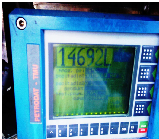
Obr.24: Počítadlo s teplotní kompenzací
