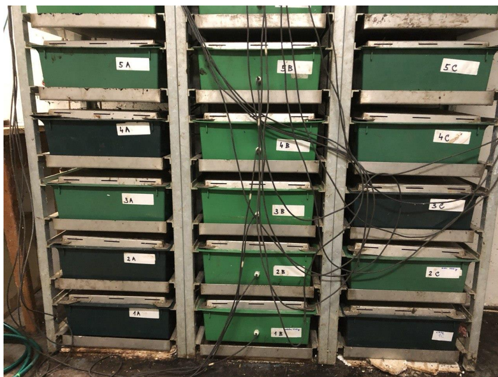
Obrázek 4: Kovová konstrukce s vermikompostovacími miskami
