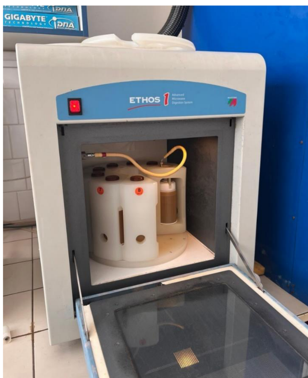
Obrázek 8: Vzorky v Milestone ETHOS 1 s rotorem HPR-1000/10S
