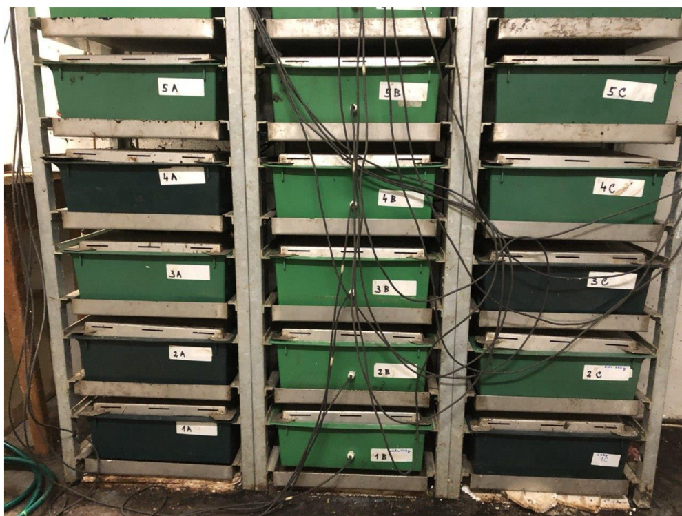
Obrázek 4: Kovová konstrukce s vermikompostovacími miskami
