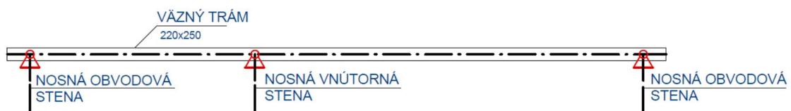
Obr. 4.4.1 Uloženie väzného trámu
