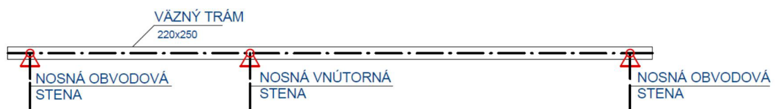
Obr. 4.4.1 Uloženie väzného trámu
