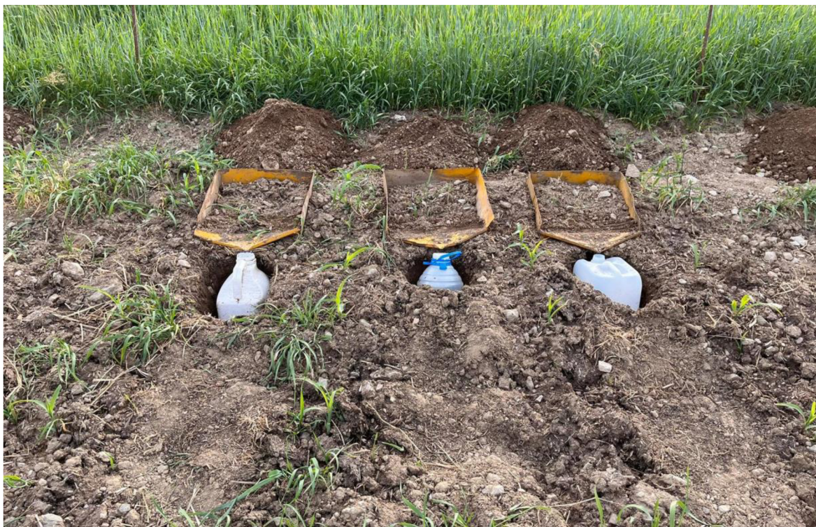
Obr. č. 6: Umístění odtokových mikroparcelek se záchytnou plochou 0,16 m 2 .
