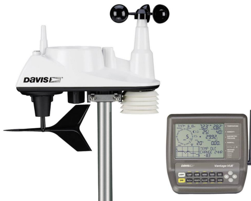
Obr. č. 7: Využívaná meteostanice Vantage Vue.
