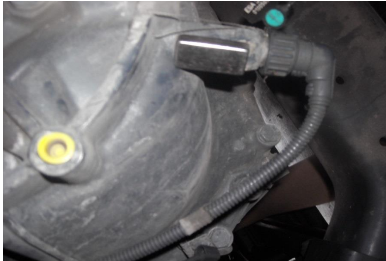
Obrázek č. 9: Instalovaný magnet na čidle záznamového zařízení
