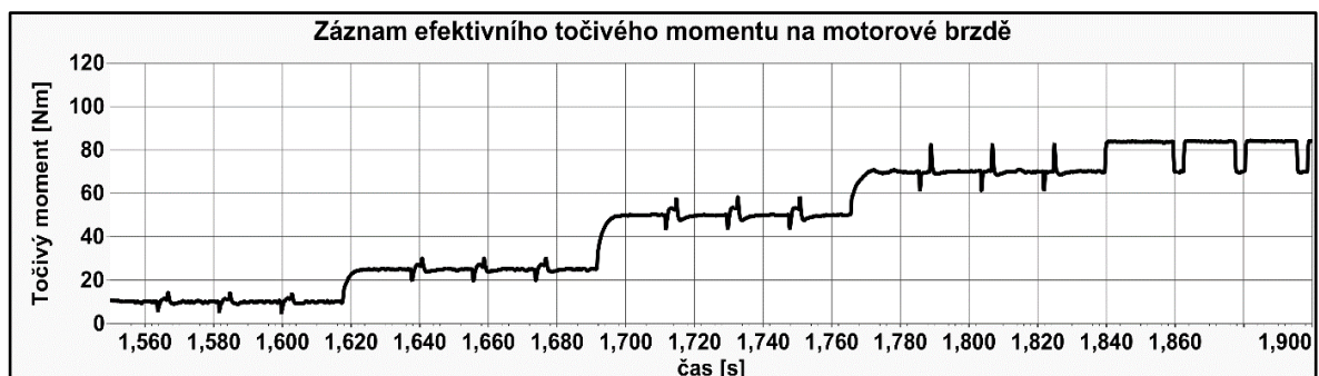
Obrázek 23: Časový záznam efektivního točivého momentu v průběhu měření.
