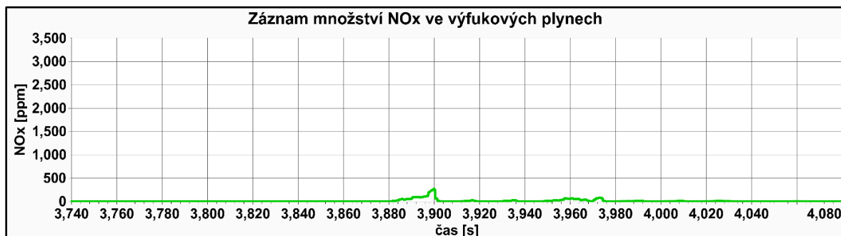
Obrázek 31: Časový záznam množství NO x na konci výfukového vedení. (za tlumičem hluku)
