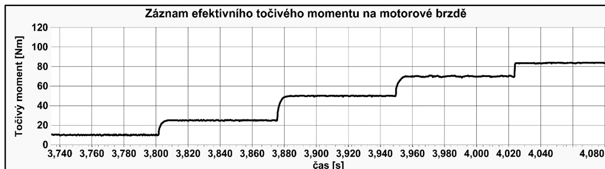
Obrázek 30: Časový záznam efektivního točivého momentu v průběhu měření.
