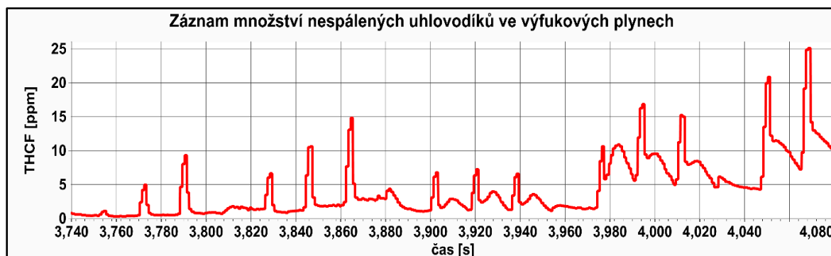
Obrázek 34: Časový záznam množství THCF na konci výfukového vedení. (za tlumičem hluku)
