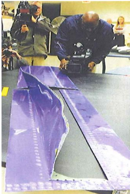
Obrázek 2-14: Důsledek mnohonásobného poškození na letadle B737-300
