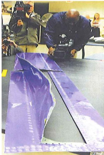
Obrázek 2-14: Důsledek mnohonásobného poškození na letadle B737-300
