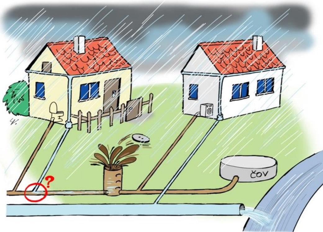
Obr. 6: Nesprávné napojení dešťových vod (BVK, ©2005–2022)
