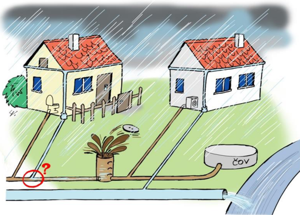
Obr. 6: Nesprávné napojení dešťových vod (BVK, ©2005–2022)
