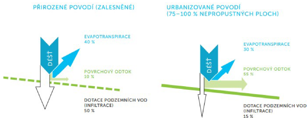
Obrázek 2.2 Porovnání odtoku srážkových vod v přirozeném a urbanizovaném prostředí [10]
