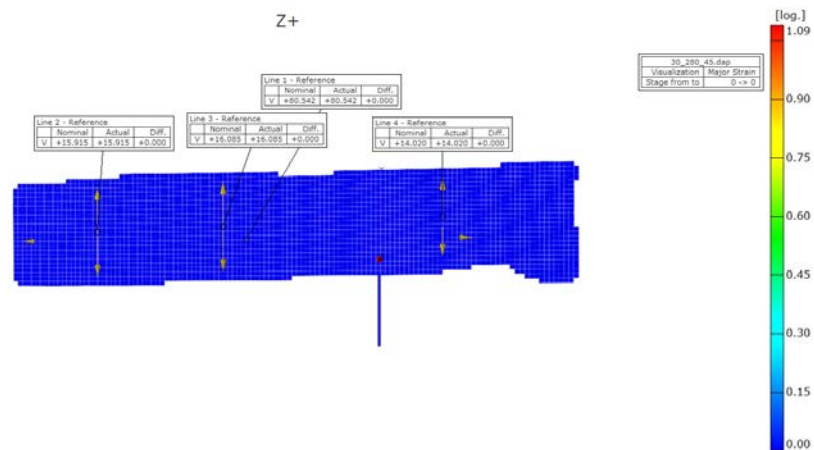
Obr. 12.23: Snímek 0 při měření vzdáleností bodů, teplota 280^\circ\text{C} , směr 45^\circ oproti směru válcování
