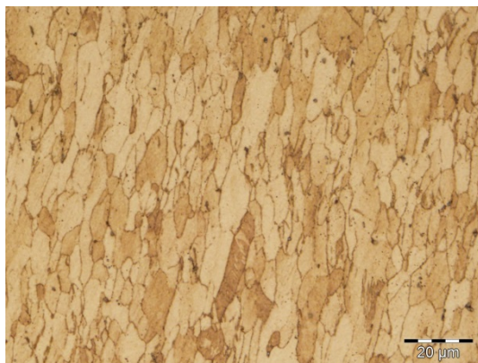
Obr. 12.61: Struktura AZ31B-O, teplota 100 °C, směr 45° na směr válcování, deformace \epsilon = 45,32\% , odebráno z plochy, lepáno
