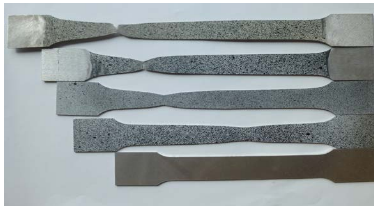
Obr. 12.2: Sada zkušebních tyčí od nezatížené, přes 22 °C, 100 °C, 230 °C až po 280 °C po SZT
