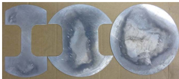
Obr. 12.35: Vzorky pro získání DMP před nástřikem: šíře 30 mm, 105 mm, 210 mm
