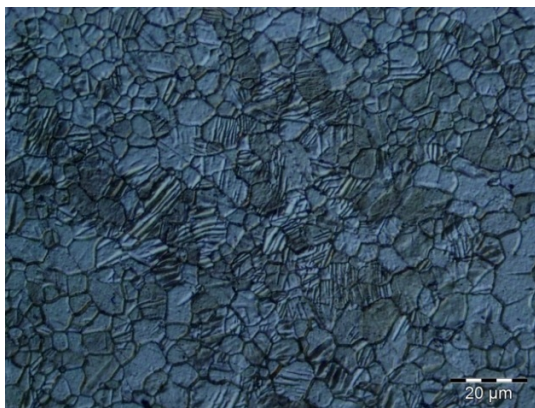
Obr. 12.59: Struktura AZ31B-O, směr 45° na směr válcování, neovlivněný materiál, odebráno z plochy, lepáno, polarizační světlo
