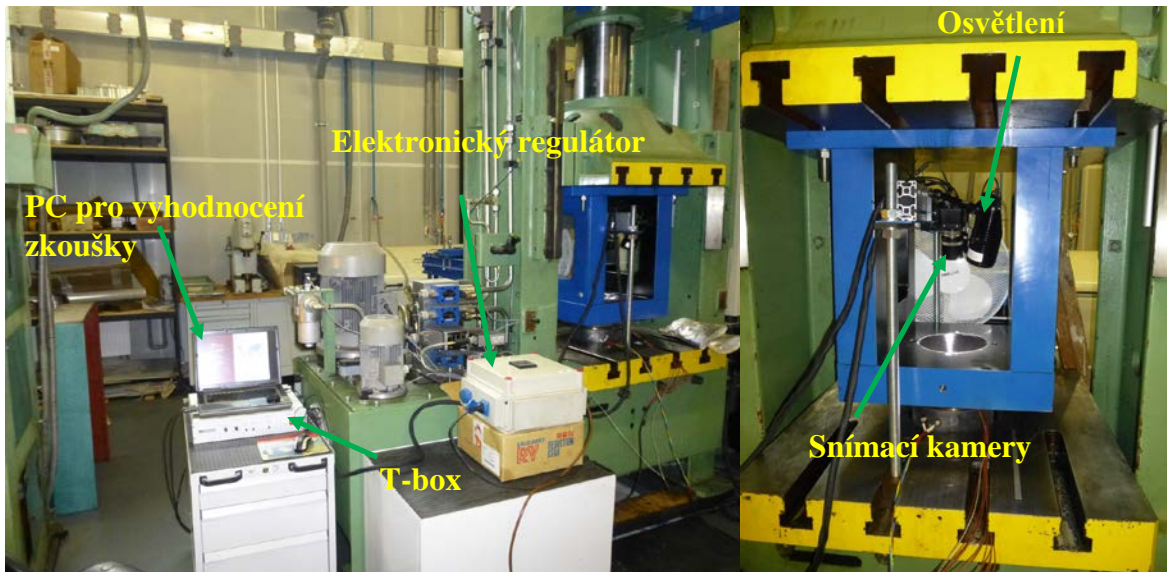
Obr. 12.29: Vlevo celkový pohled na lis CBA 300/63, vpravo snímání kamery a lisovací nástroj
