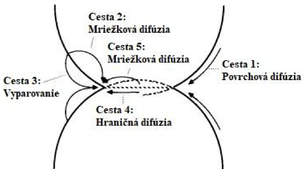
Obrázok 9: Cesty transportu materiálu pri spekaní kryštalických materiálov [5]
