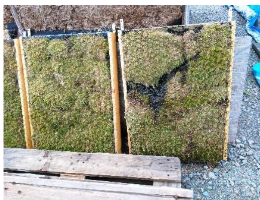
Obr. 5-8: Potrhaný panel působením hydrogelu
