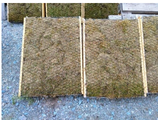
Obr. 5-7: Neprosperující panely bez integrované závlahy
