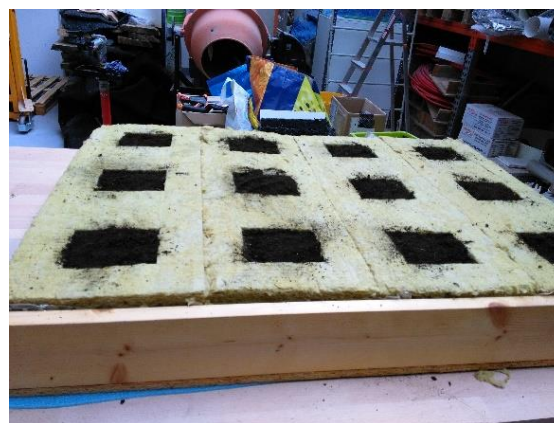
Obr. 5-16: Panel vyplněný substrátem pro výsadbu rostlin
