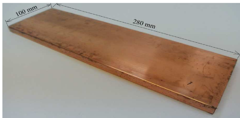
Obr. 1.1 Polotovár pro výrobu součásti z mědi Cu99,9E.
