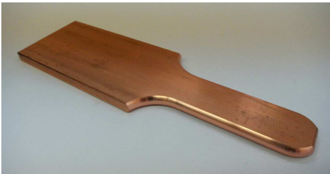
Obr. 5.1 Součást po obrobení tvarové plochy.
