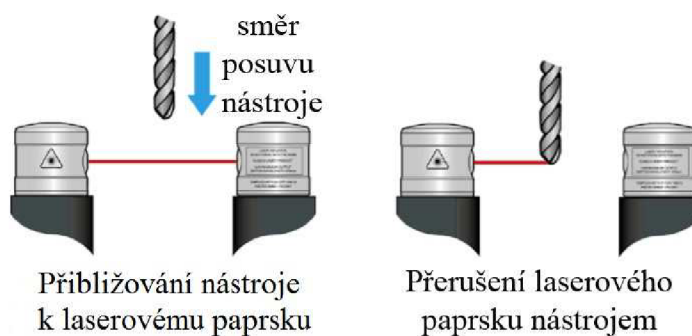
Obr. 4.5 Bezkontaktní měření nástrojovou sondou ( double-sided ) [25].
