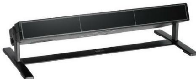
Obrázek 5 – Statický vzdálený eyetracker [12]
