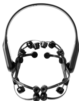
Obrázek 3.3: Elektroencefalograf Emotiv EPOC-X [3]
