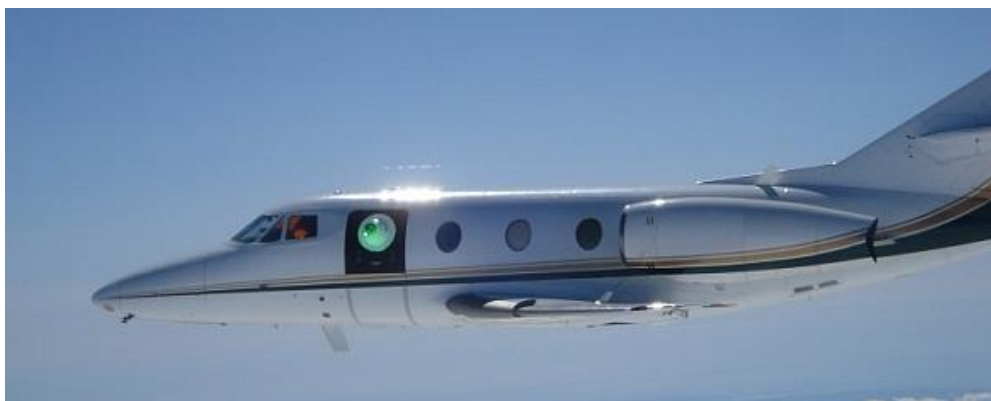
Obrázek 10.4: Testování laserové střelecké věže ABC na malém obchodním letadle [35]
