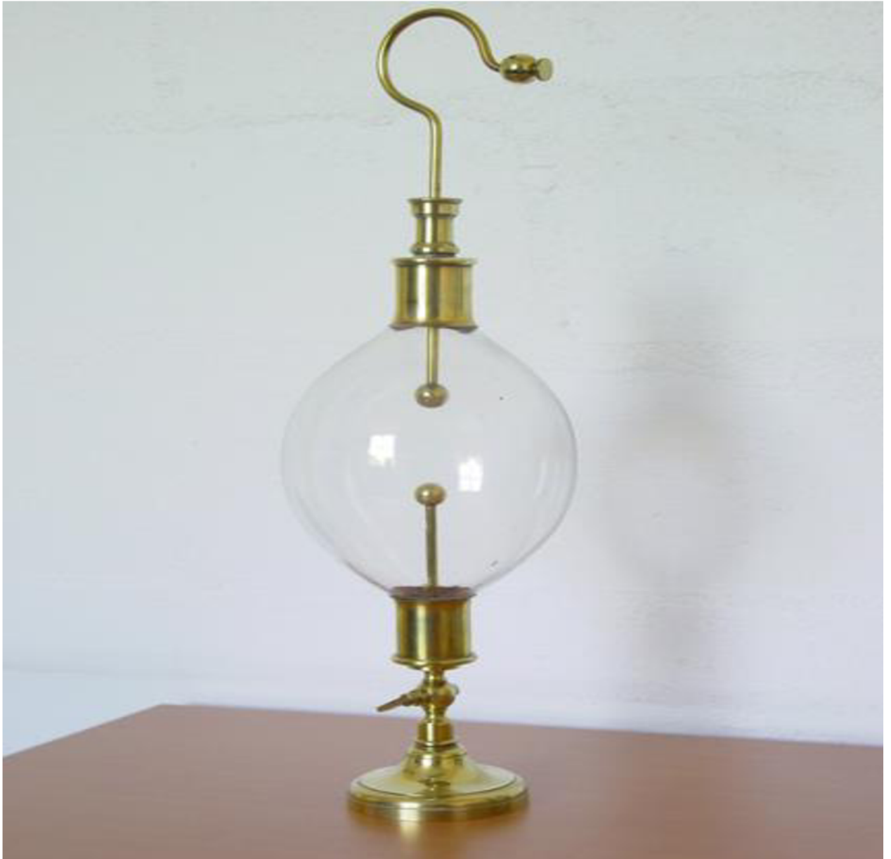
Obrázek 3: Příklad pro studium elektrických výbojů v plynech. Faradayův aparát
