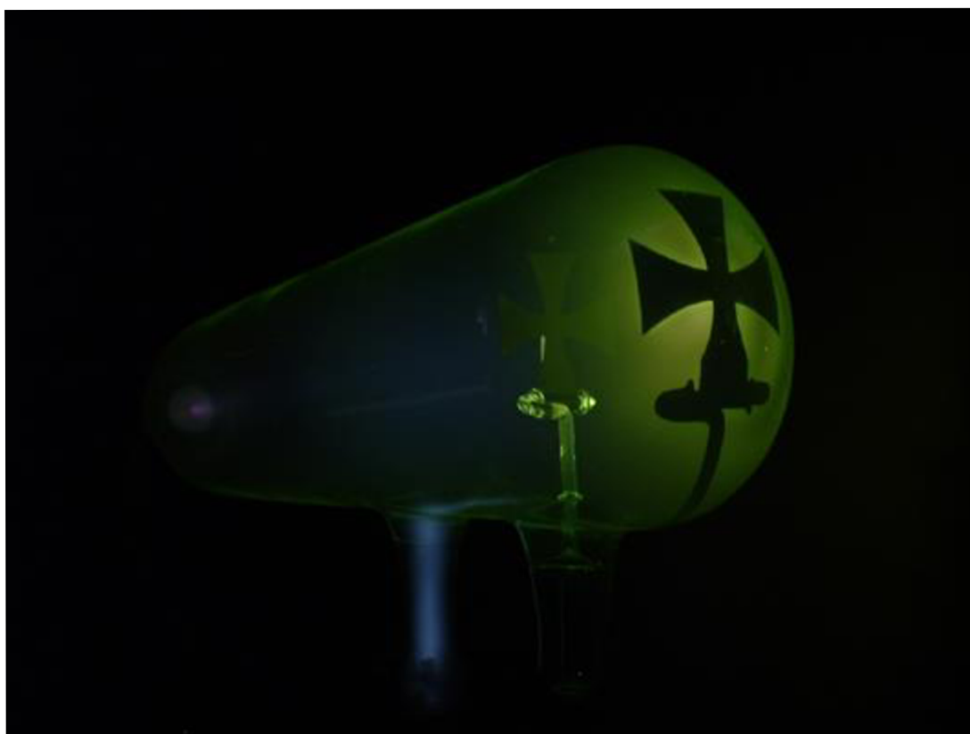
Obrázek 5. Ukázka katodových paprsků.
