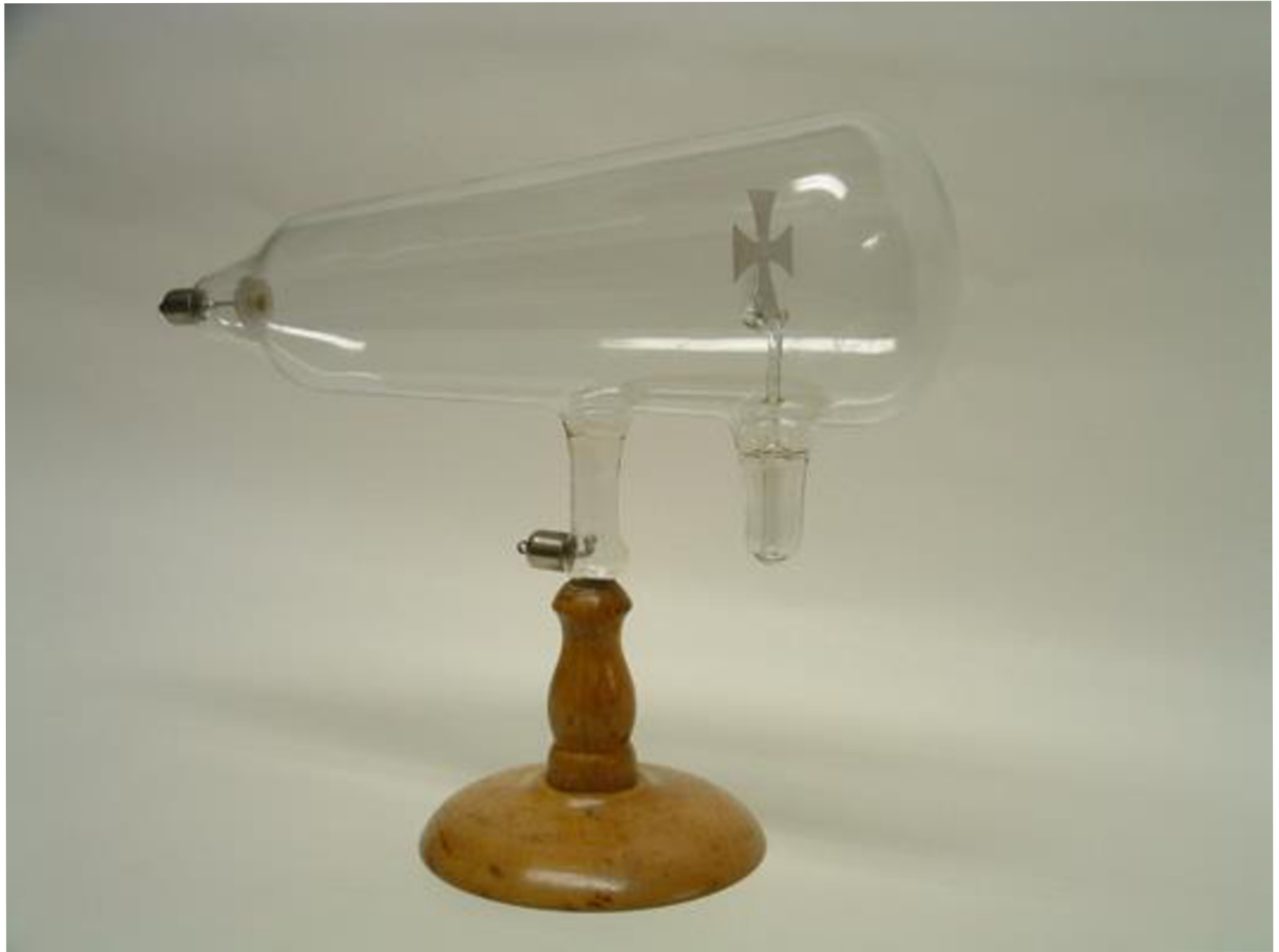
Obrázek 4. Tube de Crookes. Cathode, anode, obstacle (croix de malte). (Image : The Cathode Ray Tube site)
