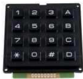
Obrázek 2.7: Ilustrační obrázek, použitá maticová klávesnice [10].
