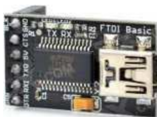
Obrázek 2.9: Převodník USB – UART s obvodem FTDI232RL [11].
