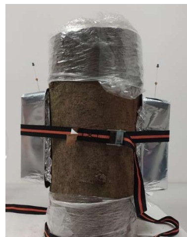
Obr. č. 25. měření přímo na výřezu pomocí SPME vlákna
