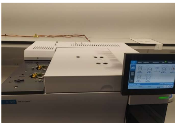
Obr. č. 21. Plynový chromatograf typ Agilent 8890 (Autor: M. Pražáková)
