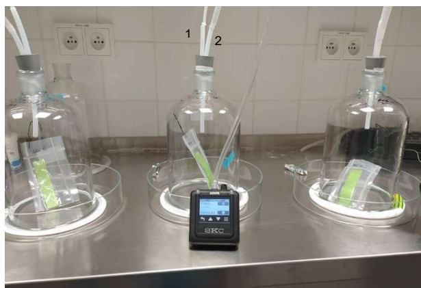
Obr. č. 14. Odběr vzorků pod zvonem (Autor: M. Pražáková)
