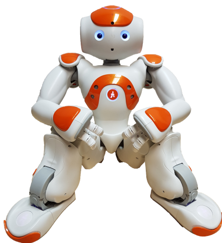
Obrázek 1.1: Humanoidní robot NAO
