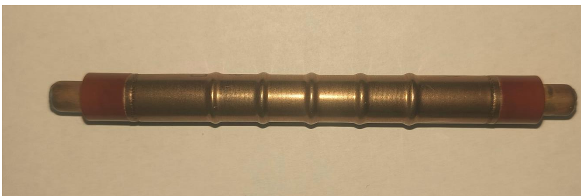
Obrázek 18: Geiger-Müllerova trubice [Vlastní zpracování]
