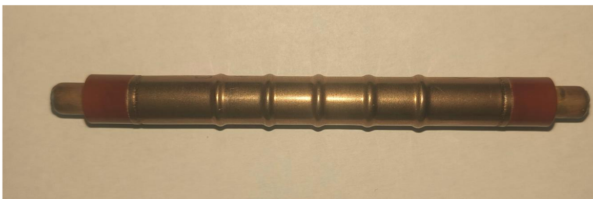
Obrázek 18: Geiger-Müllerova trubice [Vlastní zpracování]
