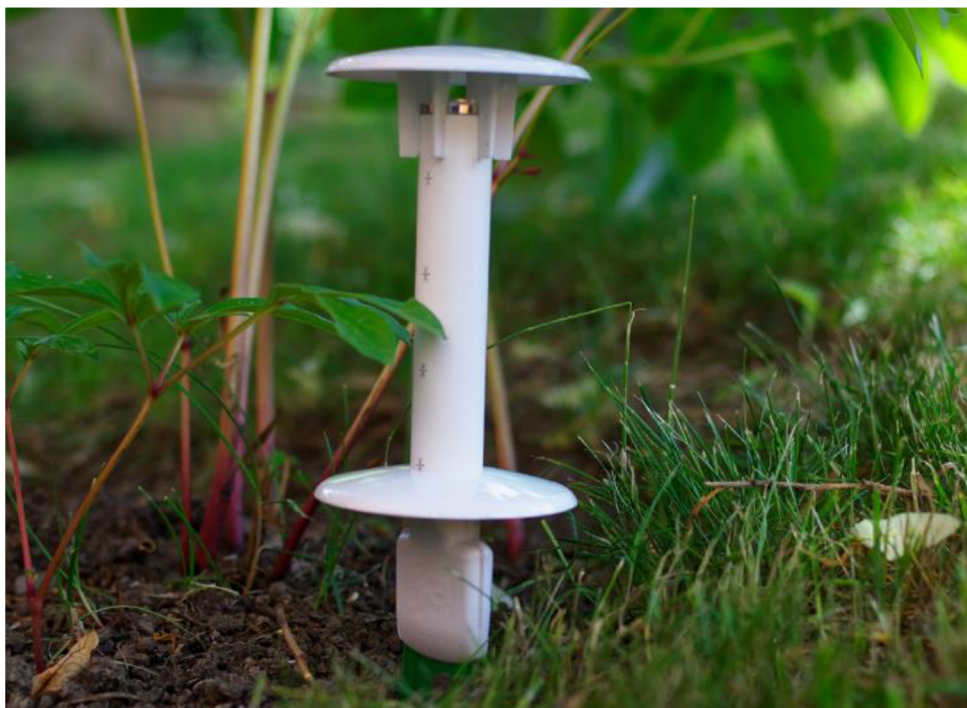
Obrázek 4 Ilustrační foto čidla TMS-4 a jeho aplikace v terénu (Zdroj: TOMST.com)
