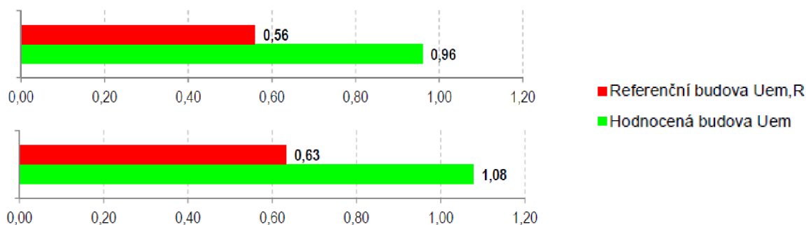
Obr. 22 Odlišnost v průměrném součiniteli prostupu tepla obálkou budovy pro variantu 1 nahoře a variantu 2 dole [W/m 2 .K]
