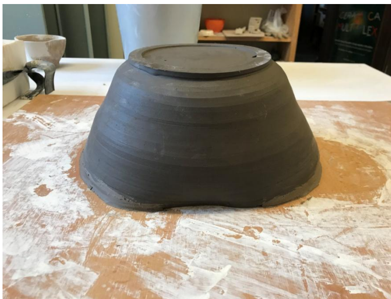
Obrázek 11. Příprava hliněného modelu na tvorbu sádrové formy
