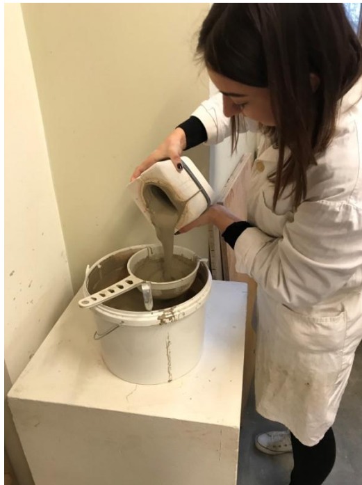
Obrázek 20. Vylití licí hmoty zpět do kyblíku
