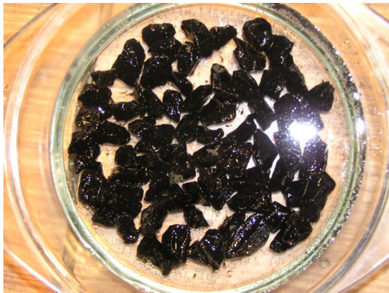
Obr. 5-10: Rozprostřené částičky obaleného kameniva po zalití destilovanou vodou a temperování
