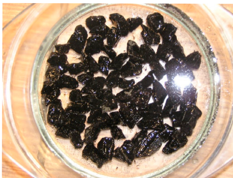
Obr. 5-10: Rozprostřené částičky obaleného kameniva po zalití destilovanou vodou a temperování
