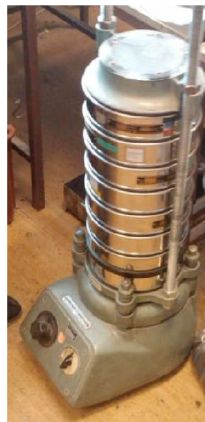
Obr. 5-6: Vibrační stroj s normovanými sítí
