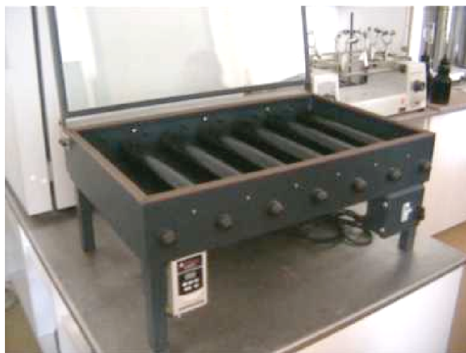
Obr. 5-12: Zařízení pro rotaci lahví [32]
