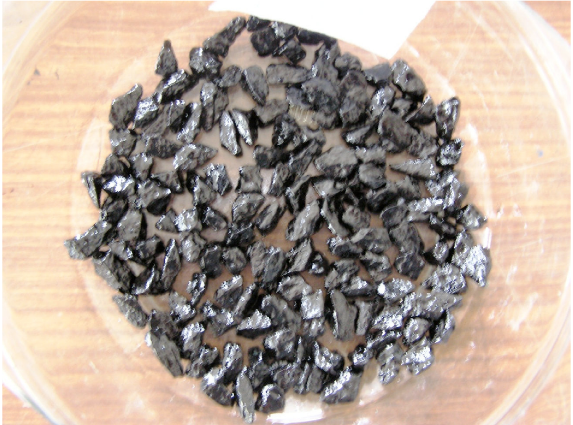
Obr. 6-3: Vzorek č. 2 pro zkoušku dle EN 12697-11: 2005
