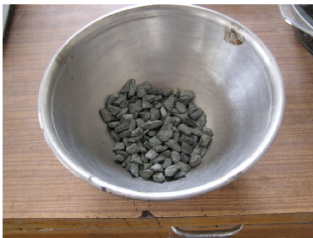
Obr. 5-14: Odpočítaných 150 zrn kameniva frakce 6/10 mm
