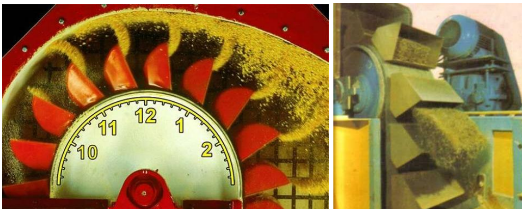
Obr. 7 Odstředivé vyprazdňování [12], gravitační vyprazdňování [13].
