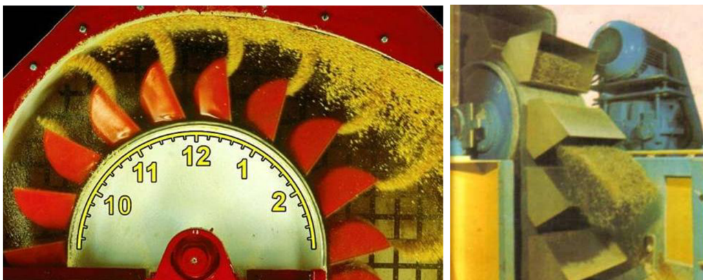
Obr. 7 Odstředivé vyprazdňování [12], gravitační vyprazdňování [13].
