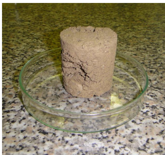
Obrázek 2.4 – Rozbor neporušeného půdního vzorku – vysušený vzorek půdy [6]
