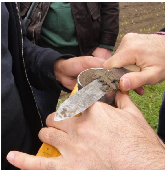
Obrázek 2.3 – Příprava neporušeného půdního vzorku k rozboru. [6]
