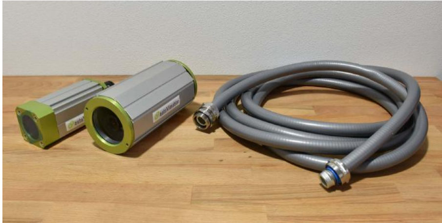
Obr. 1.16: Fotografie nových kamer a vodotěsného propojení.
