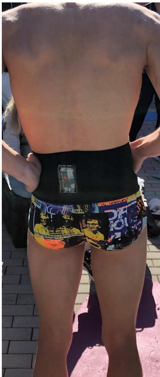
Obr. 1.9: Fotografie SwIMU v pásu na těle plavce.
