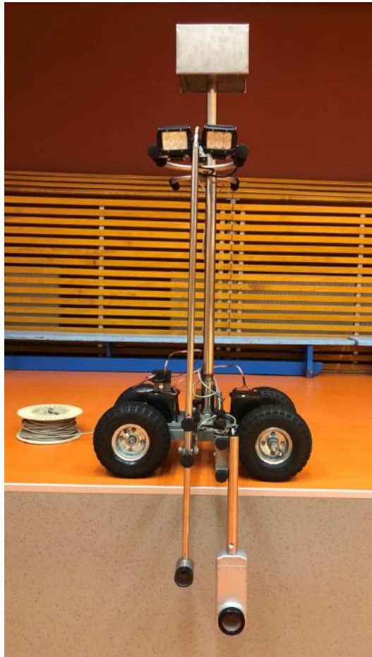
Obr. 1.8: Pojízdný kamerový systém z pohledu bazénu.
