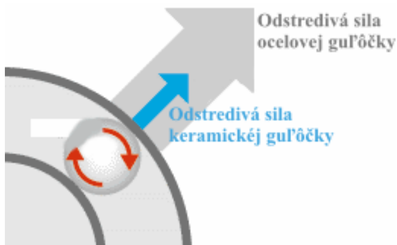
Obr. 22 Rozdiel odstredivej sily pri ocelových a keramických guľôčkach [39]
